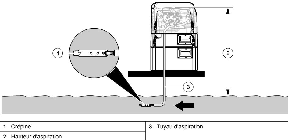
**Figure 8 Installation du tuyau d'aspiration**
