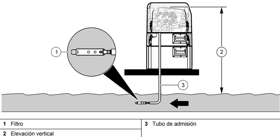
**Figura 8 Instalación del tubo de admisión**
