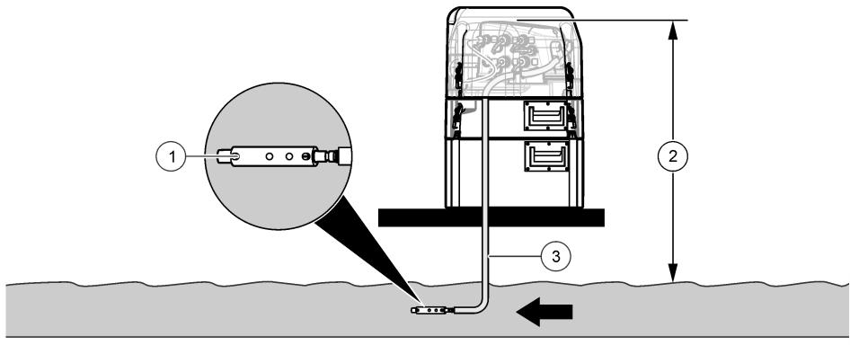
図8 取入管の取り付け
