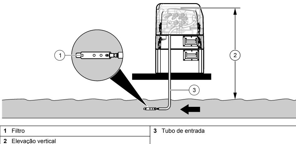
**Figura 8 Instalação do tubo de entrada**
