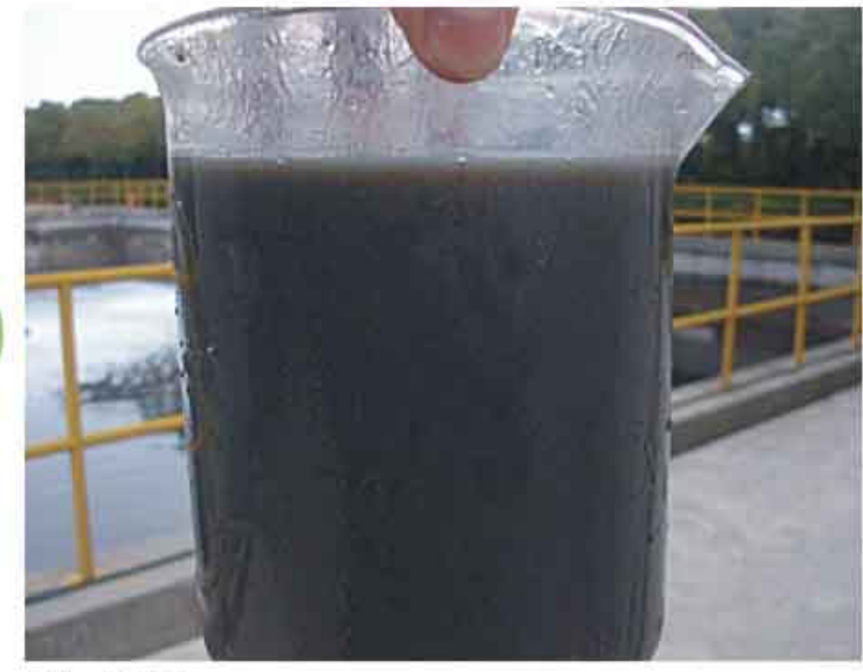
脱水前 Liquid Sludge
