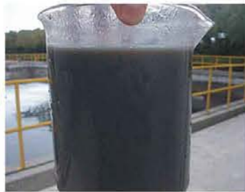
脱水前 Liquid Sludge
